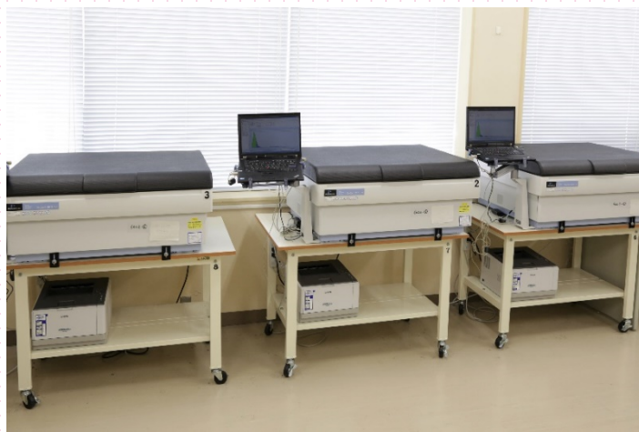
液体シンチレーションカウンタ ～トリチウム等の分析法を学べる～
