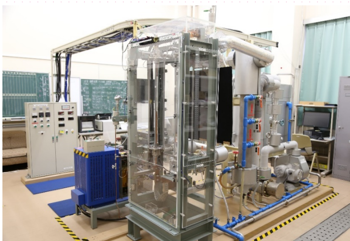
沸騰熱伝達装置 ～バーンアウト*が見られる～
