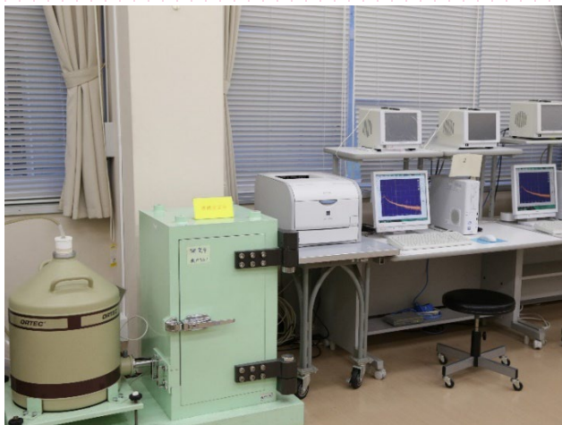
ゲルマニウム半導体検出器 ～ガンマ線核種の分析法を学べる～
