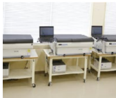
● 液体シンチレーションカウンタ
